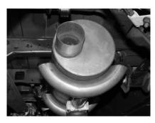
SLIDE MUFFLER # C ONTO HEADPIPE 1 ½" TO 2". THE INLET IS FACING THE MOTOR. MUFFLER INLET IS LOOKING INTO THE LOUVERS. THE MUFFLER OUTLET SHOULD BE AT THE 9 O'CLOCK POSITION.
