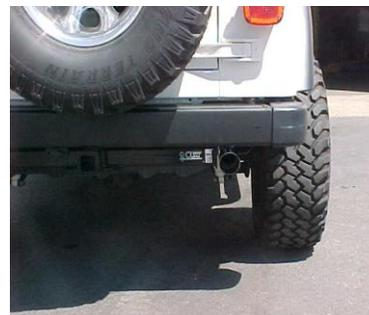
**MAKE SURE YOU HAVE A 1" CLEARANCE ON ALL BRAKE LINES, FUEL LINES, SHOCKS, TIRES, ETC.**
