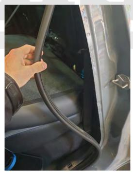
Pull back door seal on LH rear door jamb.
