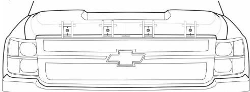
7. Retirer la pellicule de protection du bas du socle et d'adhérer à la surface du capot en communiquant avec le bord d'attaque du piédestal avec son emplacement à l'arrière de l'encadrement de grill et de rotation en place sur la surface du capot. «Humide de« surface du socle pour assurer un contact complet de l'adhésif avec la surface de la hotte. *Voir l'illustration*.
