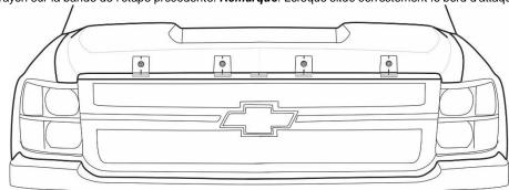
5. Scotcher temporairement les socles à la surface de la hotte dans leurs positions déterminées. Confirmez placement correct en plaçant la protection de la hotte au-dessus des quatre socles. Lorsqu'il est positionné correctement les quatre (4) trous dans la zone centrale du protecteur seront aligner avec les trous dans les chevilles. Régler si nécessaire et reconfirmer les emplacements de piédestal en utilisant les mesures de l'illustration et le protecteur de la hotte.
