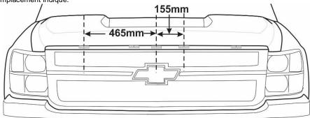
4. Installez les chevilles carrées dans le haut des socles adhésives. Utilisez l'encoche de centrage sur les piédestaux pour aligner son emplacement avec la marque de crayon sur la bande de l'étape précédente. Remarque: Lorsque situé correctement le bord d'attaque du piédestal buter contre l'arrière de la grille.
